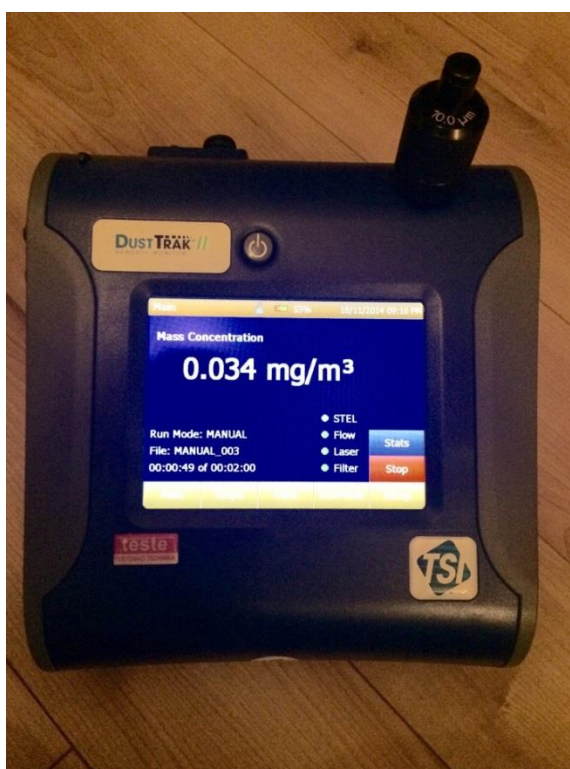
Obrázek 11 - Názorná ukázka přístroje v činnosti a jeho ovládacího panelu s nasazeným zvoleným impaktorem PM 10
