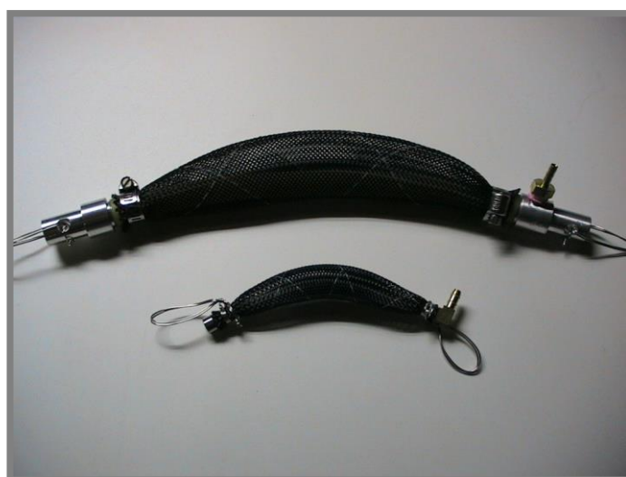
Obr. 11 Pneumatický umělý sval [17]
