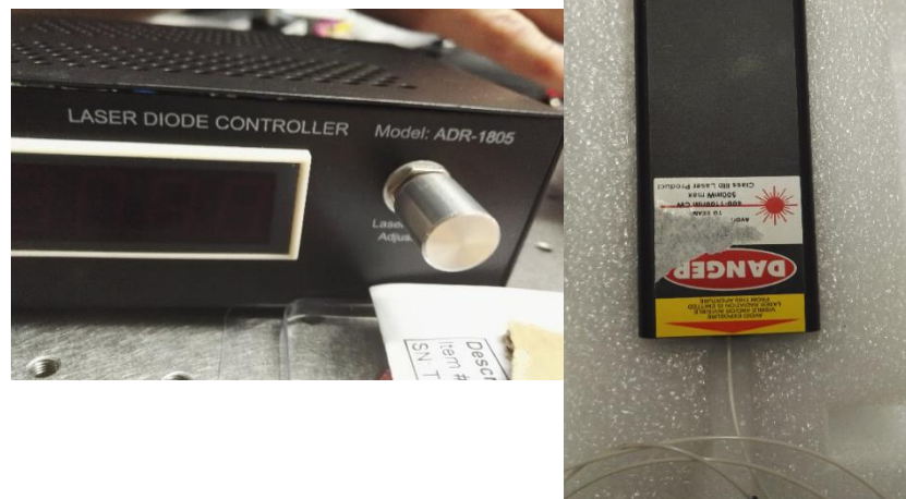
Obrázek 5-2 – Laserový zdroj ADR-1805 Vlevo je ovládací jednotka, kterou se mění intenzita laserového paprsku a vpravo je laserová jednotka, z které je navedený paprsek to optického vlákna.
