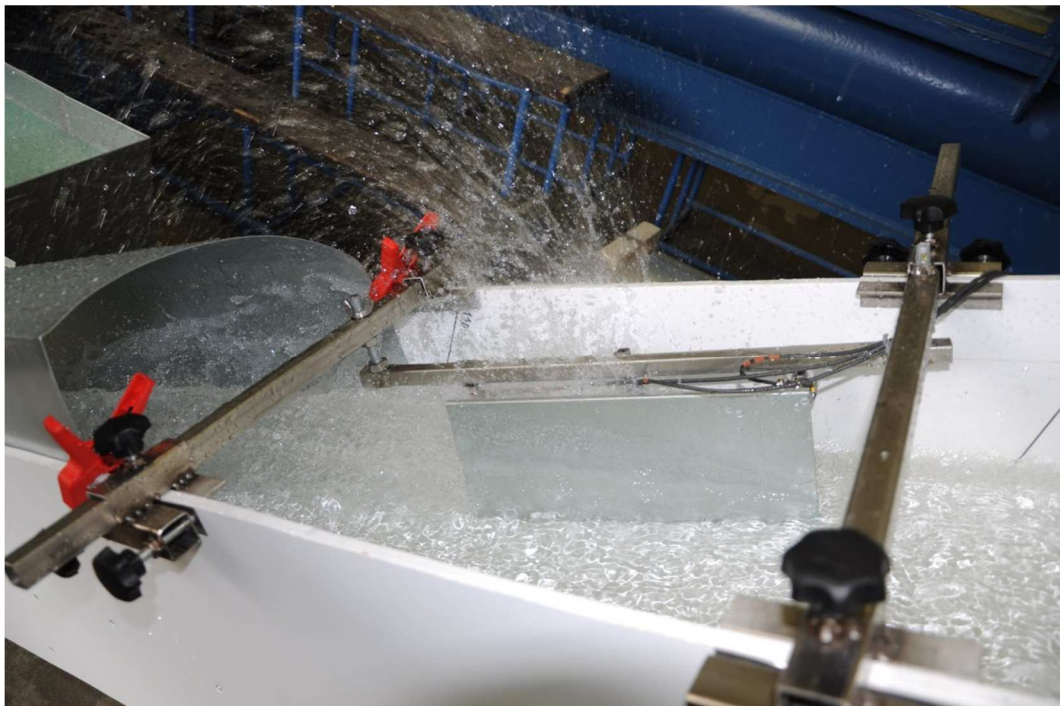
Obrázek 41 - Ovlivnění proudění při umístění u stěny žlabu [14]
