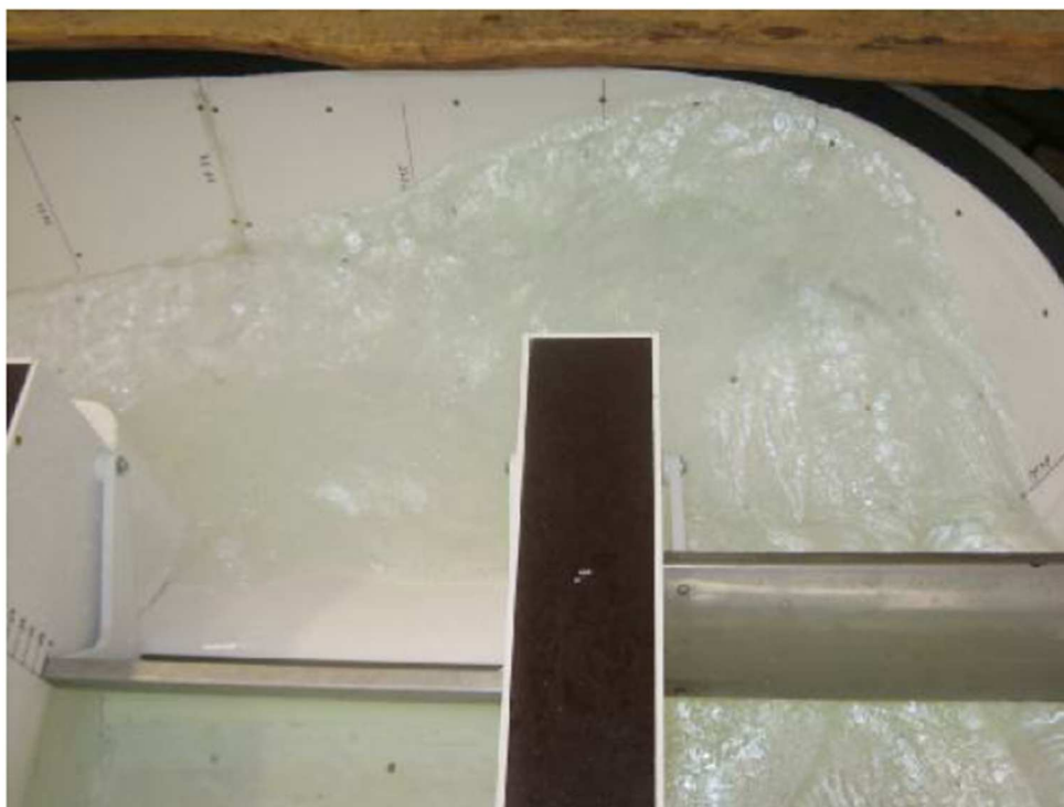
Obrázek 14 - Výstup proudu na pravé straně spadiště [2]
