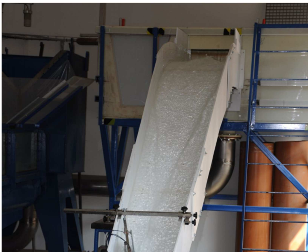
Obrázek 19 - Vznik příčných vln na hydraulickém modelu
