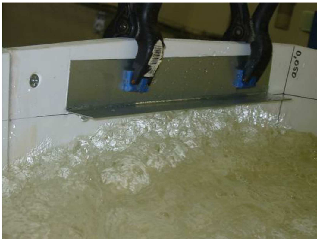
Obrázek 10 - Usměrnění maximálního výstupu příčné vlny na stěně modelu skluzu [6]
