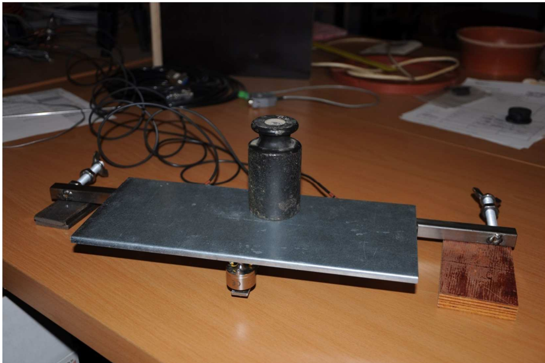
Obrázek 34 - Kalibrace pomocí závaží [14]
