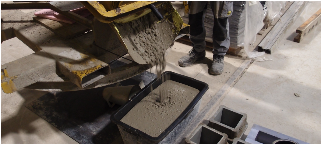
Obr. 3.2: Odběr čerstvého betonu
