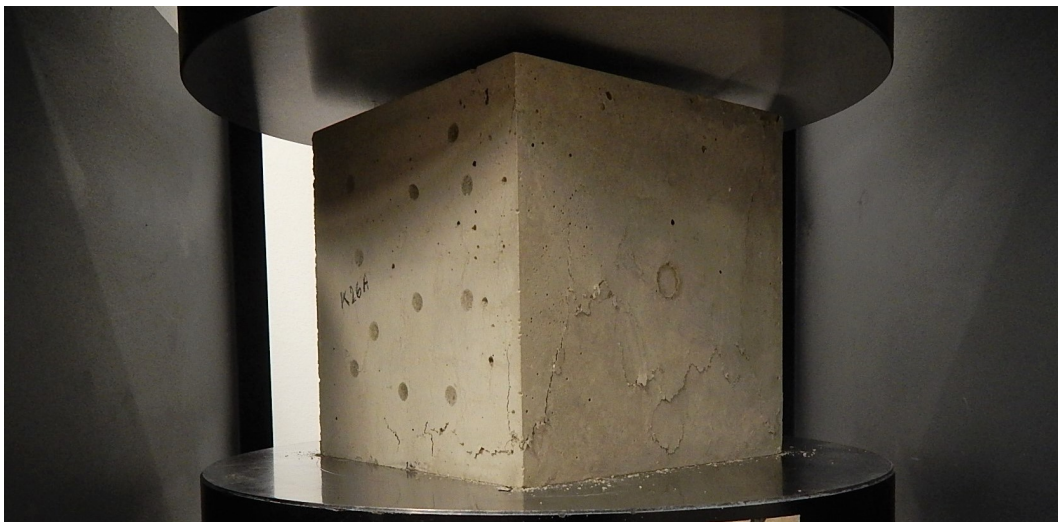
Obr. 3.5: Příklad porušení tlakem – krychle K26-A
