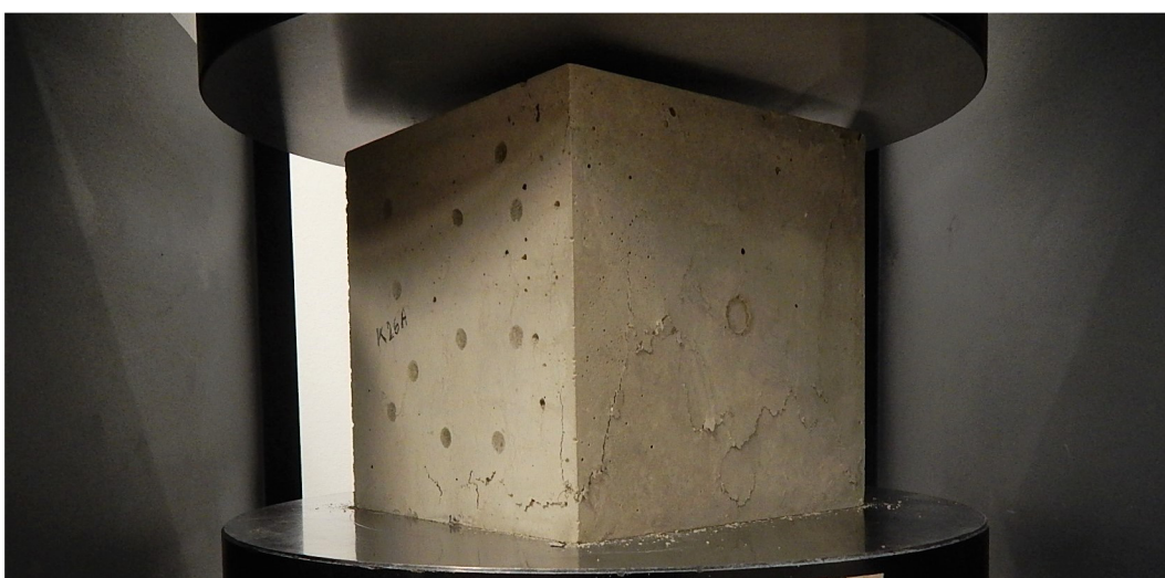
Obr. 3.5: Příklad porušení tlakem – krychle K26-A
