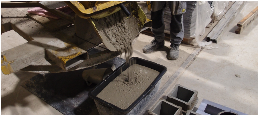
Obr. 3.2: Odběr čerstvého betonu
