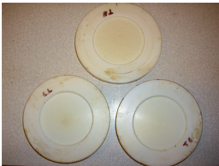
Obr. 2 Teflonové formy pro výrobu zkušebních vzorků
