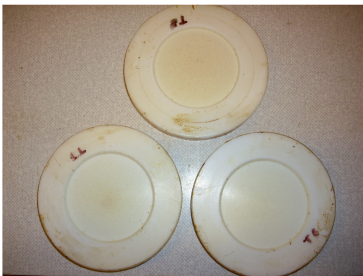
Obr. 2 Teflonové formy pro výrobu zkušebních vzorků
