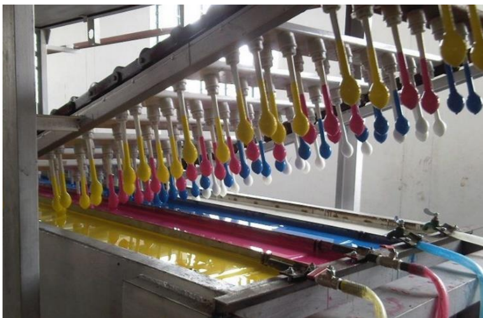
Obrázek 3.12: Diskontinuální technologie máčení (publi.cz, 2022)
