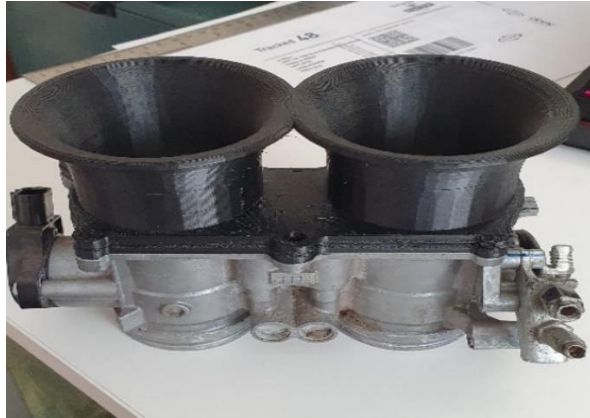
Obrázek 5.6: Rychlostní zásobníky z Mazdy Miata vyrobené z PETG (reddit.com, 2022)
