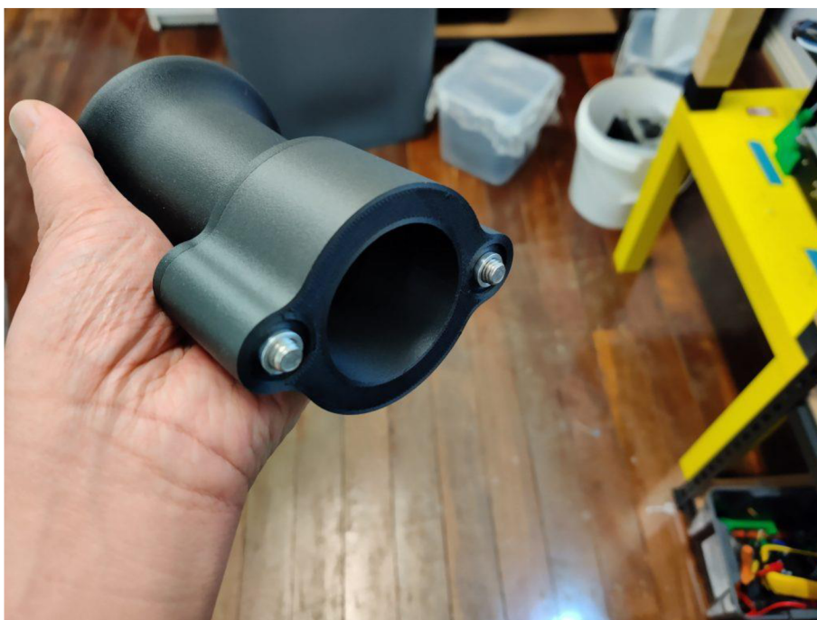
Obrázek 5.4: Distanční vložka vyrobená z PA (learn.colorfabb.com, 2022)
