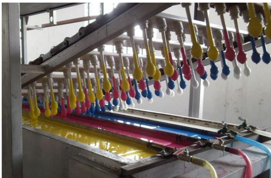
Obrázek 3.12: Diskontinuální technologie máčení (publi.cz, 2022)
