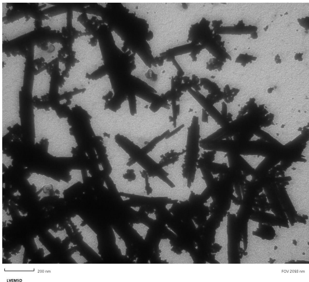
Obr. 9: Nanočástice mědi na laboratorně připravovaném oxidu železitém s 10% obsahem mědi pořízené transmisí elektronovou mikroskopií
