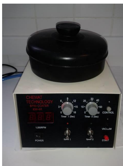
Obr. 9: Zařízení pro rotační nanášení (spin-coater) KW-4A firmy Chemat technology používaný v této práci
