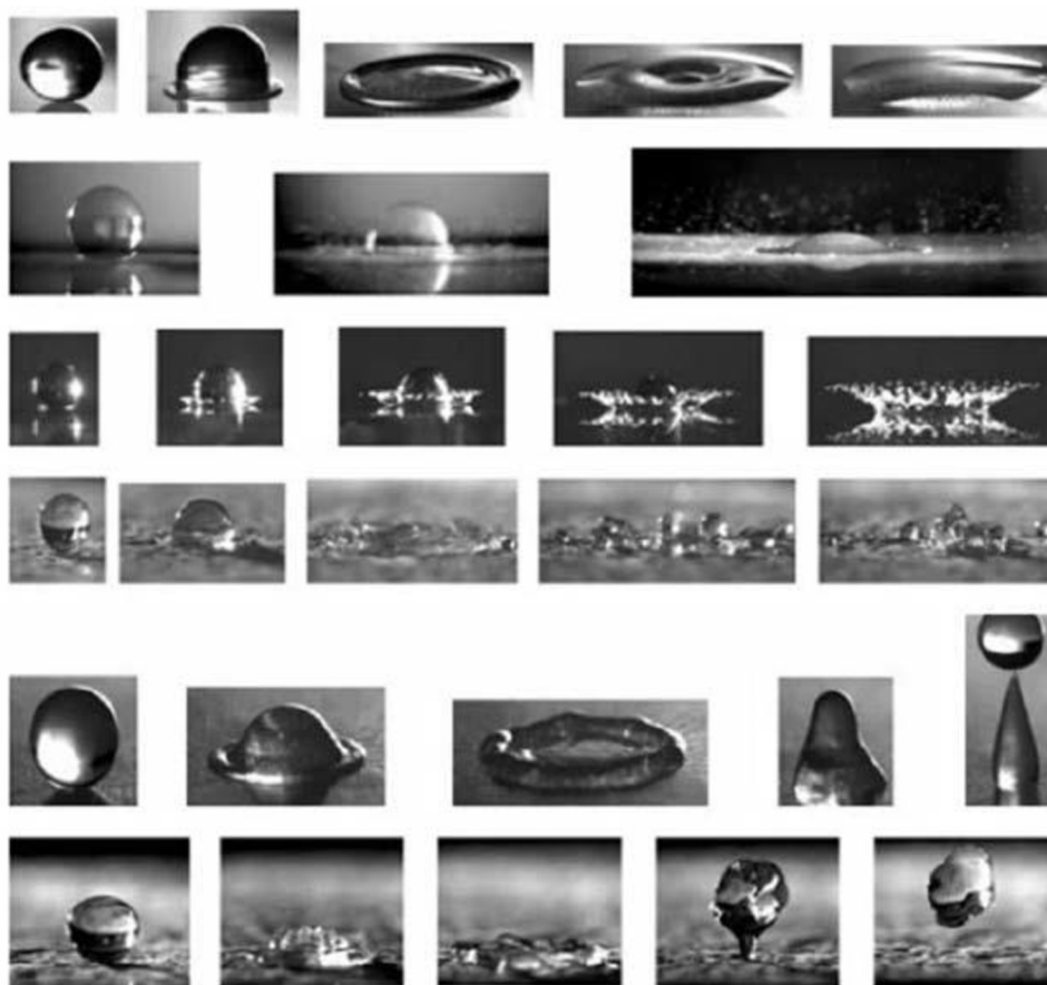
Obr. 11: Chování kapky tištěného materiálu těsně po kontaktu s povrchem substrátu [26]
