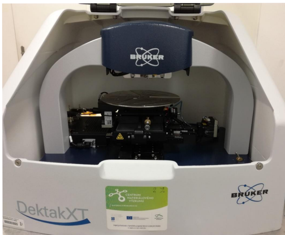
Obr. 19: Mechanický profilometr Bruker Dektak XT využívaný v této práci
