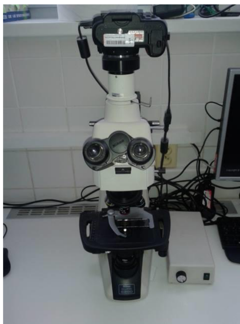
Obr. 16: Mikroskop Nikon Eclipse E200 s fotoaparátem Nikon D5000 používaný v této práci
