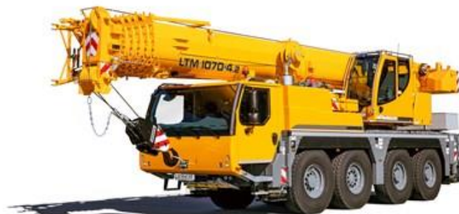
Obr. 45: Autojeřáb LIEBHERR LTM 1070-4,2 [31]
