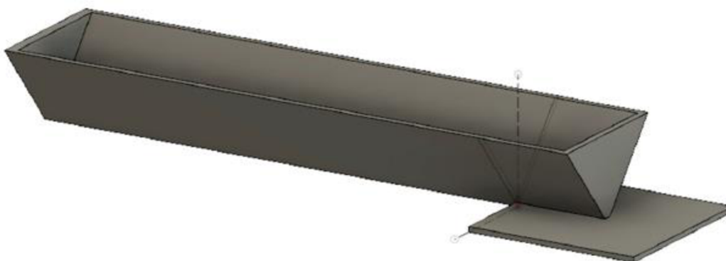
Obrázek 8 Trojrozměrný model testovacího tělesa pro warping
