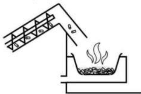
Obrázek 4.6 Topeniště se shazováním paliva do pánevního ohniště [19]
