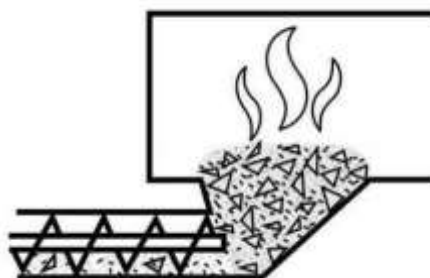
Obrázek 4.2 Topeniště se spodním přívodem paliva [19]
