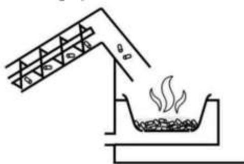
Obrázek 4.6 Topeniště se shazováním paliva do pánevního ohniště [19]
