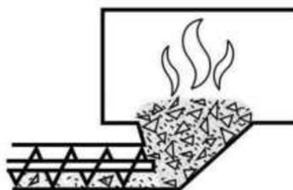
Obrázek 4.2 Topeniště se spodním přívodem paliva [19]
