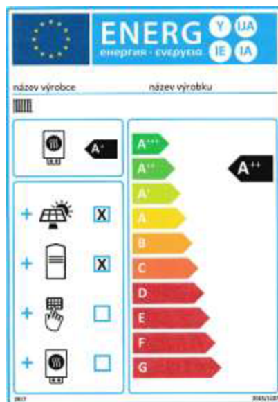
Obrázek 6.1 Příklad energetického štítku pro soupravu v třídě A++, sestávající z kotle na tuhá paliva třídy A+, solárních kolektorů a zásobníku teplé vody [18]
