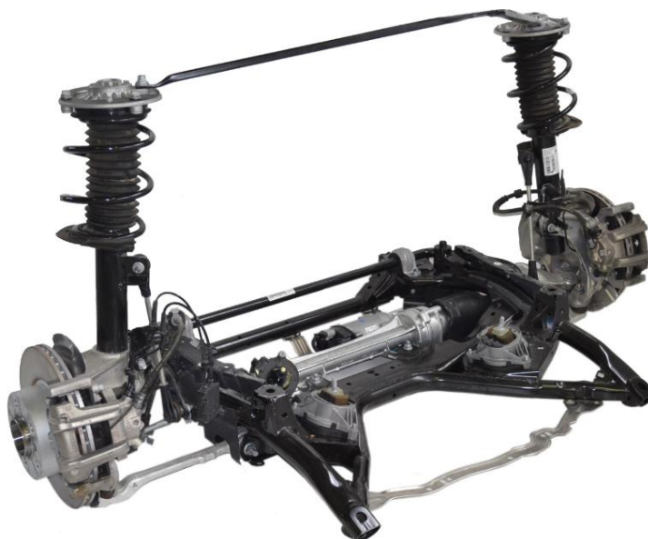
Obr.1.14 – Náprava Mc-Pherson (BMW 320d) [23]
