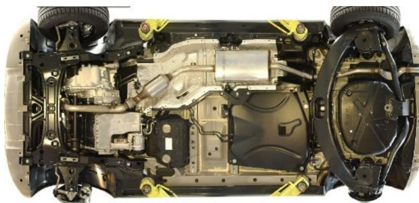
Obr.1.10 - Zadní kloubová náprava (Mercedes-Benz A 170) [23]
