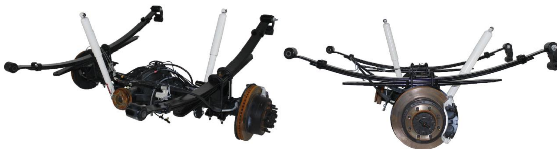
Obr.1.5 – Náprava s podélnými listovými pružinami (Ford F250) [23]
