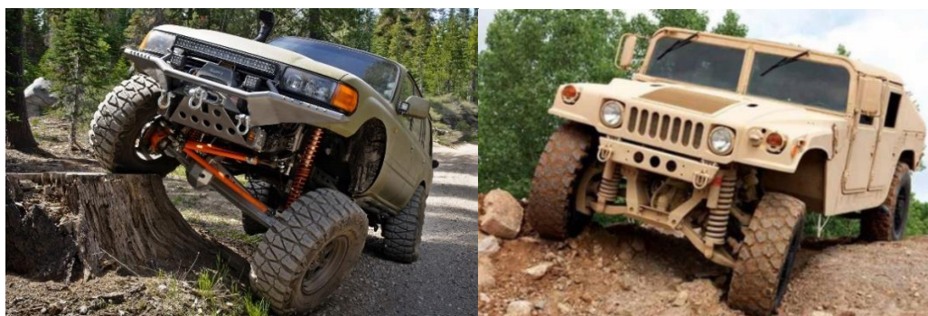
Obr.1.3 – Srovnání nezávislého a závislého zavěšení kol (Toyota Land Cruiser FJ80, Hummer h1 „Humvee“) [17],[18]
