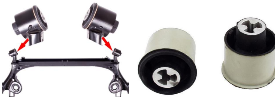
Obr.1.11 – Způsob uchycení pryžového lůžka (VW Golf IV Limo)
