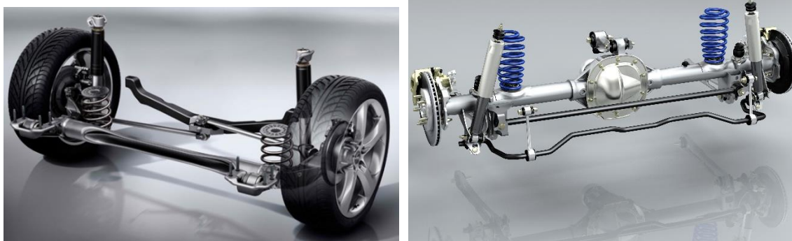
Obr.1.9 – Náprava s Panhardskou tyčí a Wattovým přímovodem (Opel Astra GTC, Ford Mustang GT) [21],[22]
