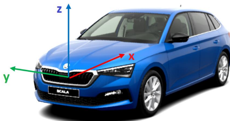
Obr.2.1 – Výchozí globální souřadnicový systém automobilu
