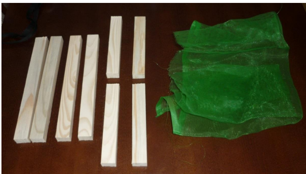
Obrázek 31: Materiál na síto a dřevěný rám
