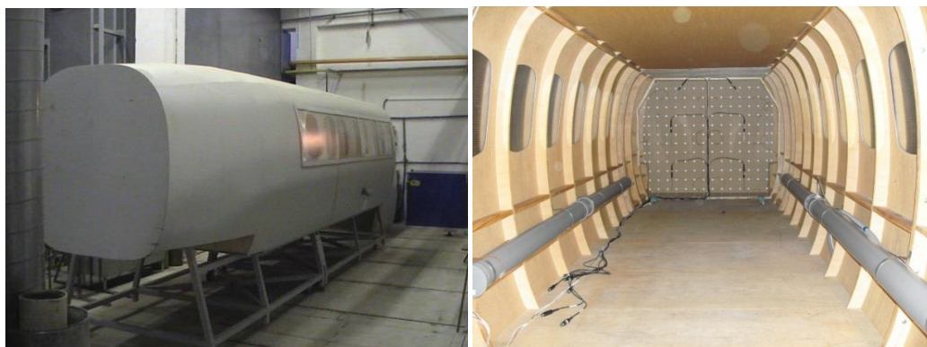
Obrázok 13 Maketa kabíny umiestnená v laboratóriu (v pravo- vnútorné prostredie kabíny bez zateplenia)
