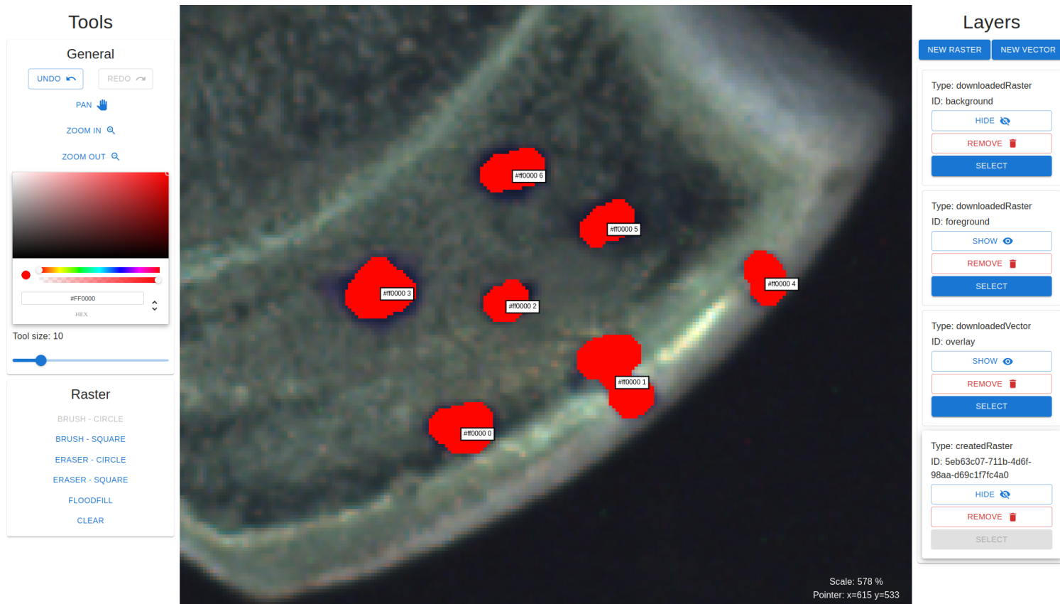
Obrázek 4.10: Snímek obrazovky demonstrační aplikace s detekovanými bloby červenou barvou s jejich textovým označením barvy a ID.
