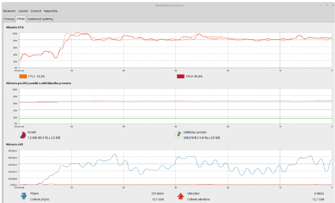
Obr. 3.10: Vytížení systému na 80-90% po spuštění mixu/translátoru nízký bitový tok
