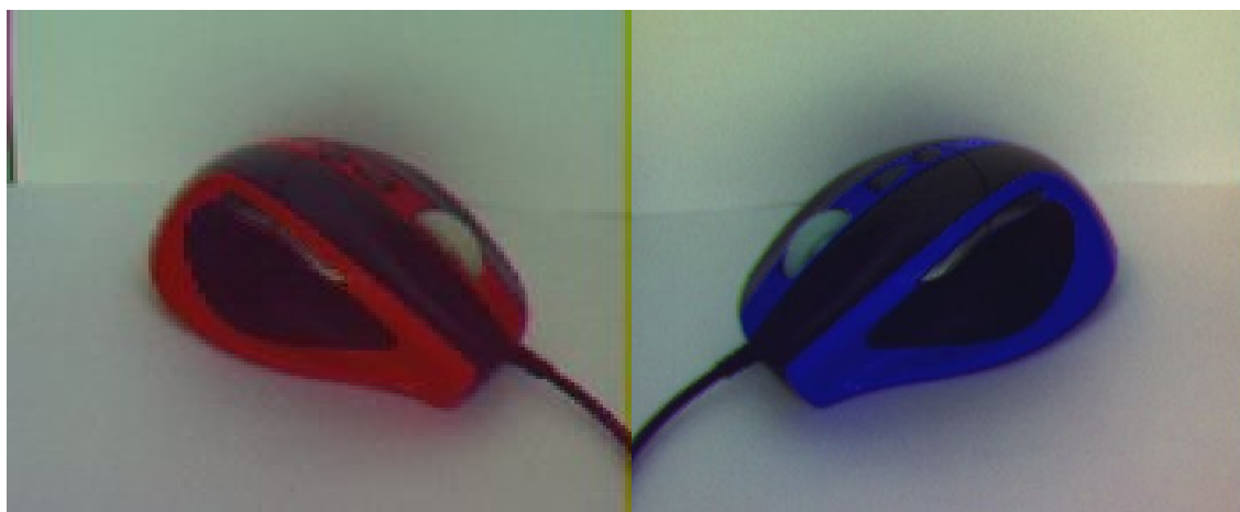
Obr. 61 – Snímky při (lepších světelných podmínkách) rozlišení 176x144 (vlevo) a 352x288px s aplikací funkci PCLK polarity (vpravo).
