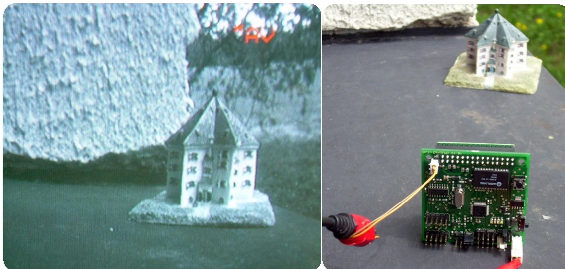
Obr. 56 – Fotografie z testování analogové videosekvence. (Kamera byla připojena do modulu CMUcam3 z důvodů zajištění stabilního napájení 5V.)
