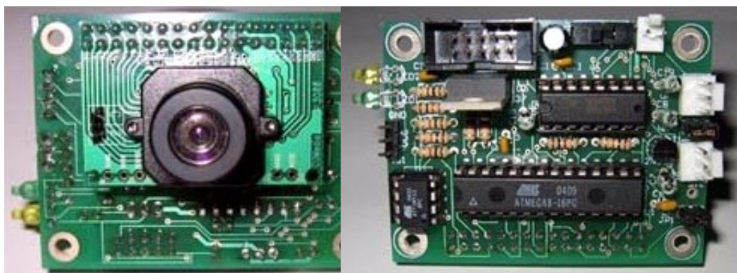
Obr. 26 – Přední strana modulu AVRcam (vlevo) a jeho zadní strana (vpravo). [37]
