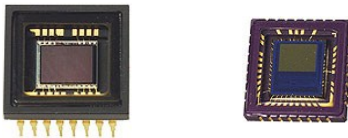
Obr. 2 – CCD čip o velikosti 1/3 palce (vlevo), CMOS čip o velikosti 1/4 palce (vpravo). [5]
