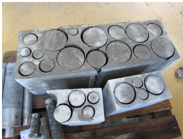
Obr. 11 Zkušební tělesa – jádrové vývrty průměrů 50, 75, 100 a 150 mm (LB1).
