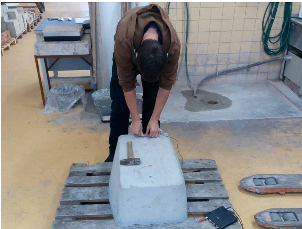
Obr. P11 Zkušební těleso vybetonované do plastové nádoby (LB2)
