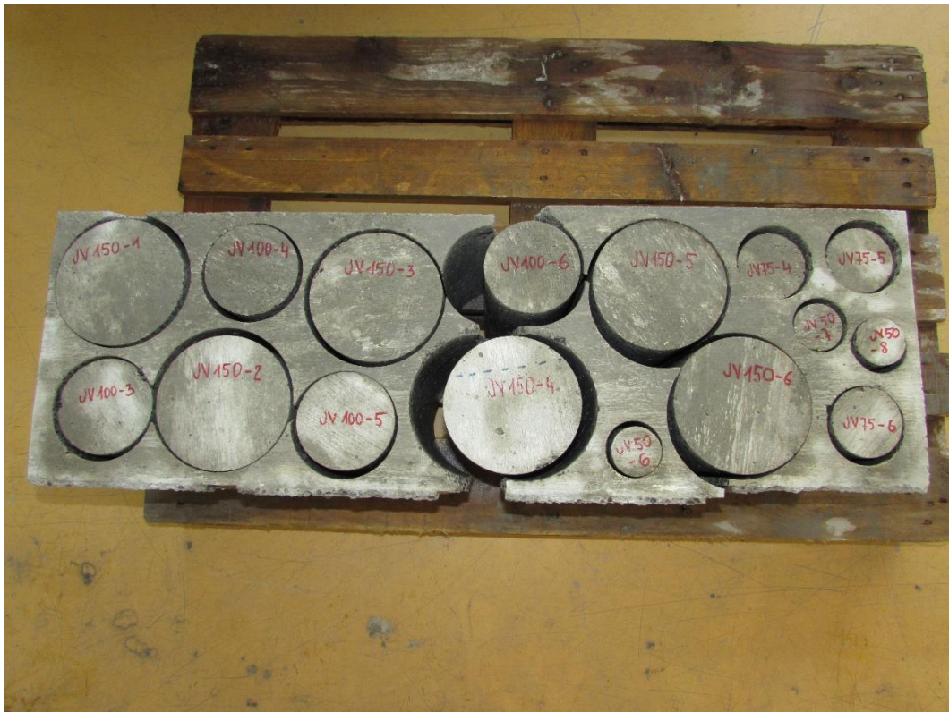
Obr. P5 Těleso T300/900 a vývrty z něj (LB1).
