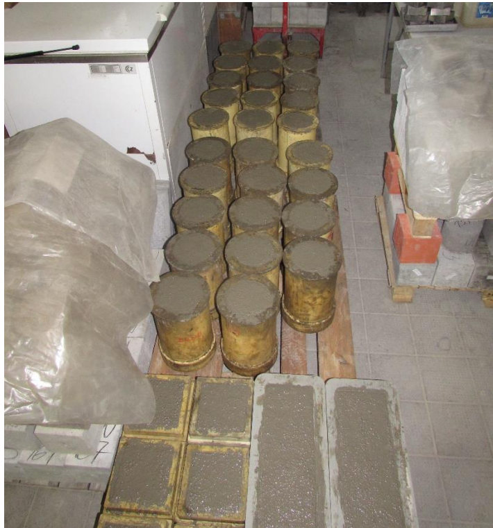
Obr. P1 Výroba těles LB1 dne 26. 5. 2017. U betonáže jsem nebyl přítomen, foto poskytl vedoucí práce
