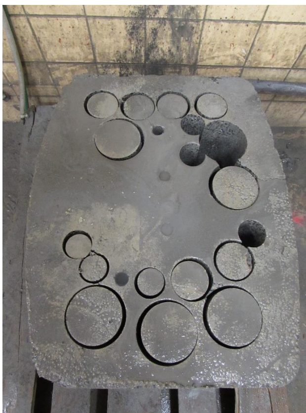
Obr. P12 Jádrové vývrty a původní těleso (LB2).
