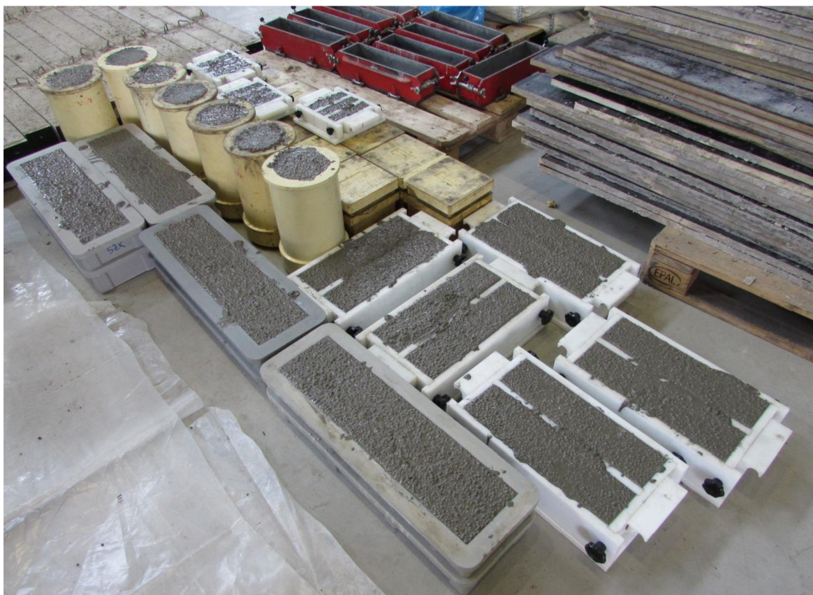
Obr. P9 Výroba těles LB2 dne 17. 4. 2018. U betonáže jsem nebyl přítomen, foto poskytl vedoucí práce
