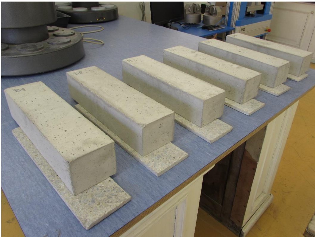
Obr. 19 Zkušební tělesa po prvním seříznutí.
