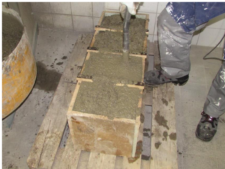
Obr. P2 Výroba těles LB1 dne 26. 5. 2017. U betonáže jsem nebyl přítomen, foto poskytl vedoucí práce
