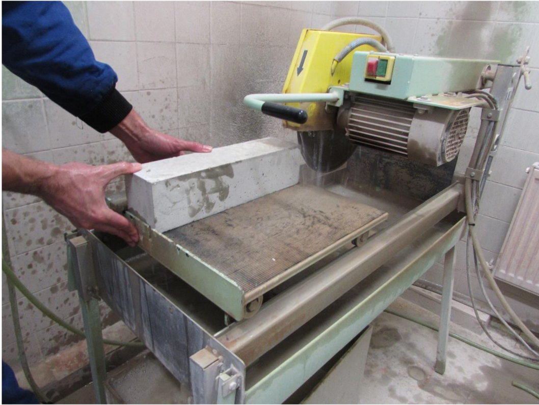
Obr. 18 Řezání původního tělesa.
