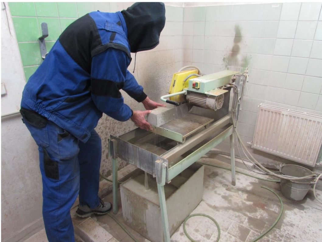
Obr. P14 Řezání základních těles – experiment č. 2.
