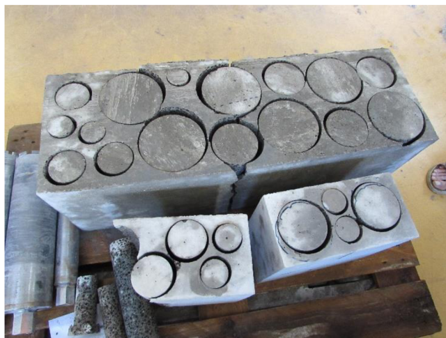
Obr. 11 Zkušební tělesa – jádrové vývrty průměrů 50, 75, 100 a 150 mm (LB1).
