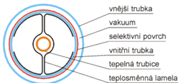
Obr. 12 Řez Heat-pipe trubicí
