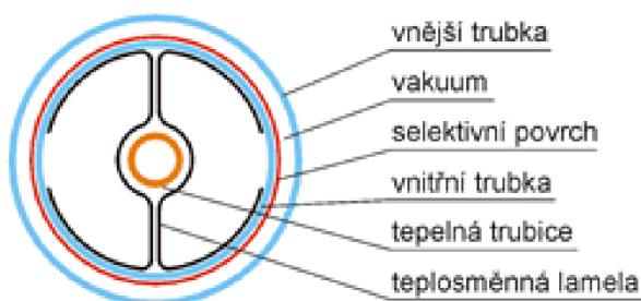
Obr. 12 Řez Heat-pipe trubicí
