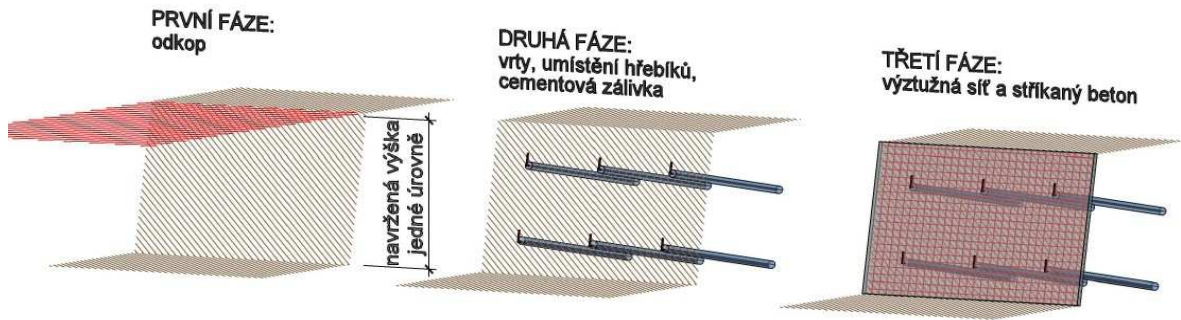
Obr. č. 6 Fáze provádění hřebíkované stěny
