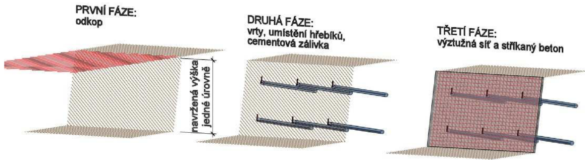
Obr. č. 6 Fáze provádění hřebíkové stěny
