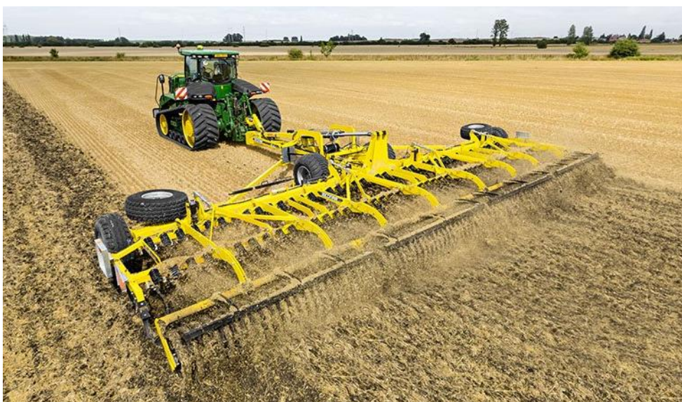
Obr. 3 ATLAS AM je tažený širokozáběrový podmítač – pracovní záběr 12 m [9]
