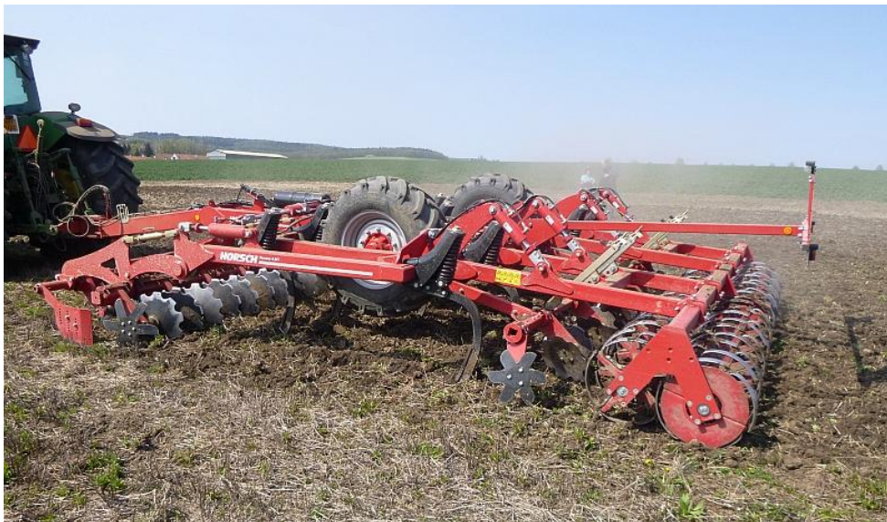
Obr. 2 Kombinovaný talířoradličkový kypřič Terrano MT pro provádění více operací [8]
