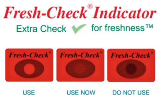
Obrázek 3 Indikátor času a teploty Fresh-Check®, kdy vlevo: potravina je v pořádku, uprostřed: potravina se musí, co nejrychleji spotřebovat, vpravo: potravina již není požitelná [51]
