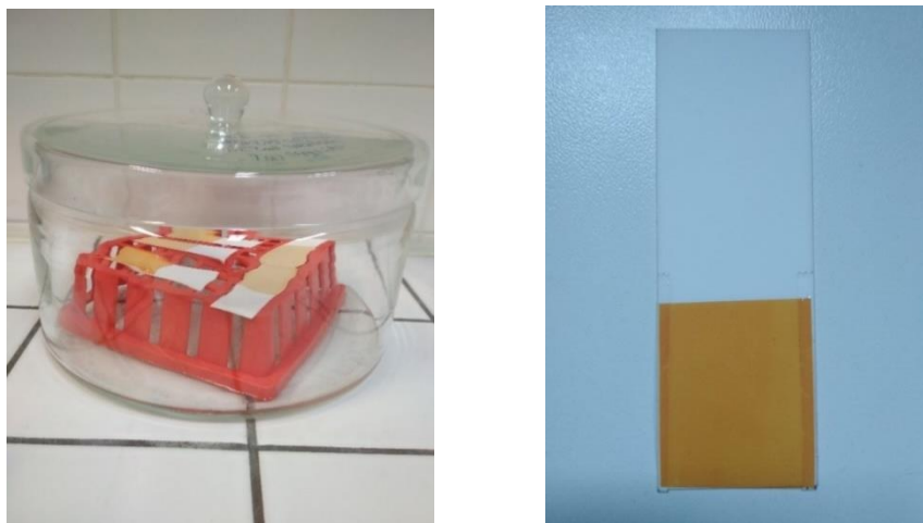
Obrázek 18 Exikátor s přichystanými vrstvami k měření při relativní vlhkosti 90 % (vlevo) a připravená vrstva podlepena na keramickou destičku oboustrannou páskou (vpravo)
