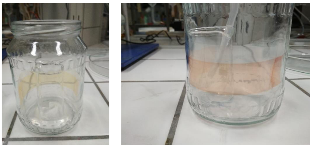
Obrázek 16 Změna barvy zkušební vrstvy při hraniční hodnotě amoniaku (75 mg) ve skleněné lahvi s ventilkem
