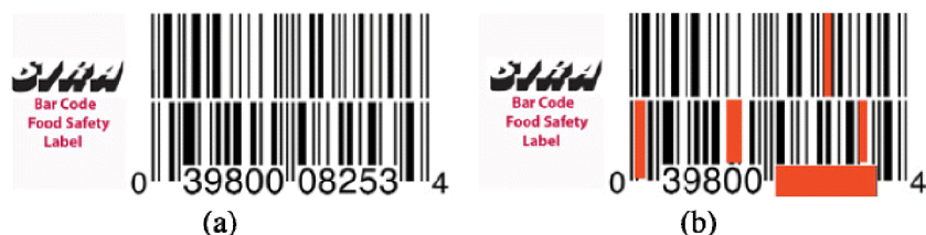
Obrázek 2 Biosenzor Food Sentinel System od firmy SYRA. a) výrobek připraven ke konzumaci, b) výrobek již není určen ke spotřebě a je u něj znemožněno skenování [44]
