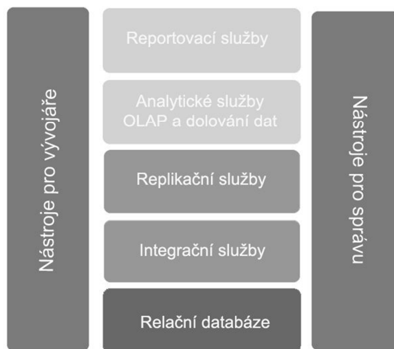
Obrázek 4.1: Architektura Microsoft SQL Serveru. Převzato a upraveno z [24].
