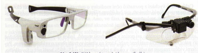
Obr. 6: Stacionární a náhlavový typ oční kamery. (Zdroj: Vysekalová et. al, 2012)
