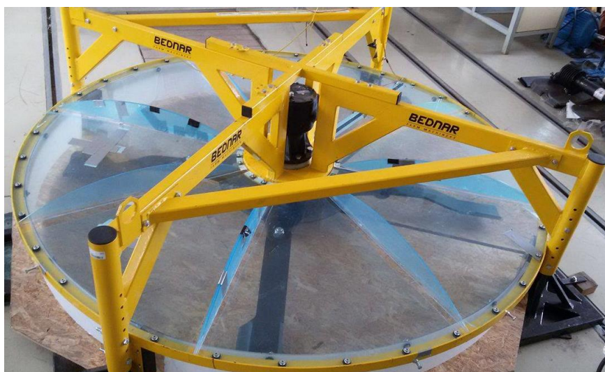
Obr. 20: Model mulčovacího stroje při použití rovných krytů
