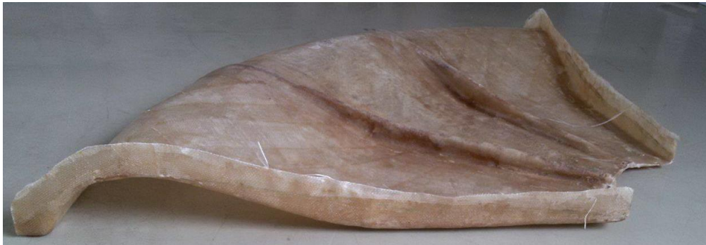
Obr. 22: Jedna čtvrtina horního krytu tvaru „kapka“
