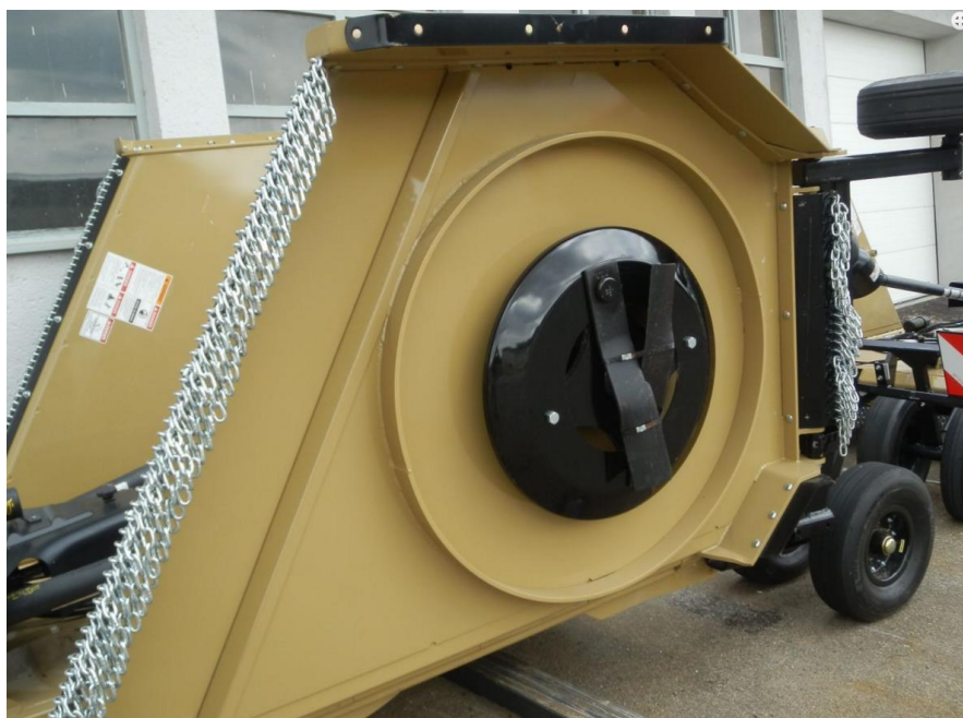
Obr. 8: Mulčovač s vertikální osou rotace [11]
