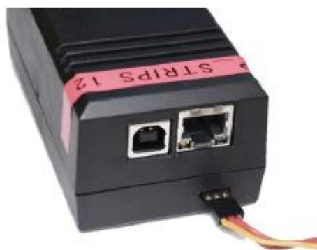
Obr. 30: centrální jednotka pro vyčítání dat [19]
