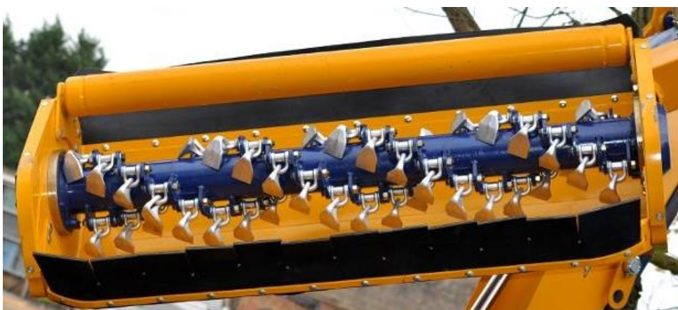
Obr. 3: Mulčovač s horizontální osou rotace [7]
