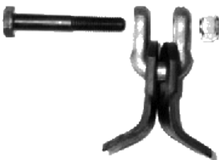
Obr. 5: Y nůž vhodný pro mulčování kukuřice a travin [10]
