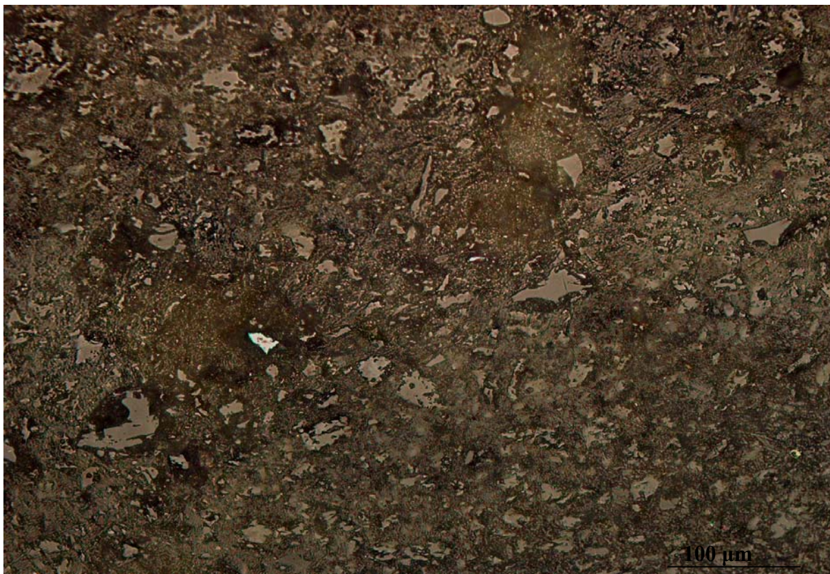
Obrázek č.30: 200x zvětšený výbrus cementového materiálu s přidavkem 7,5%hm. polymerního latexu SB 5813, analyzováno optickým mikroskopem v nepolarizovaném světle
