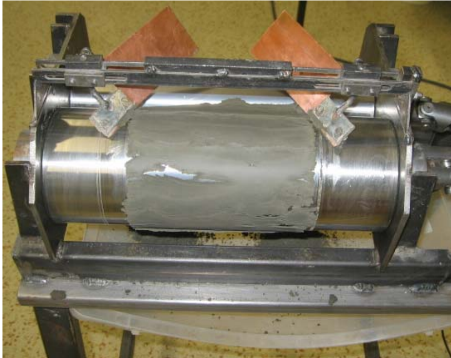
Obrázek č.20 - detail pracovního prostoru twin-roll mixeur s ukázkou nesoudržnosti pasty na válci a její následné popraskání
