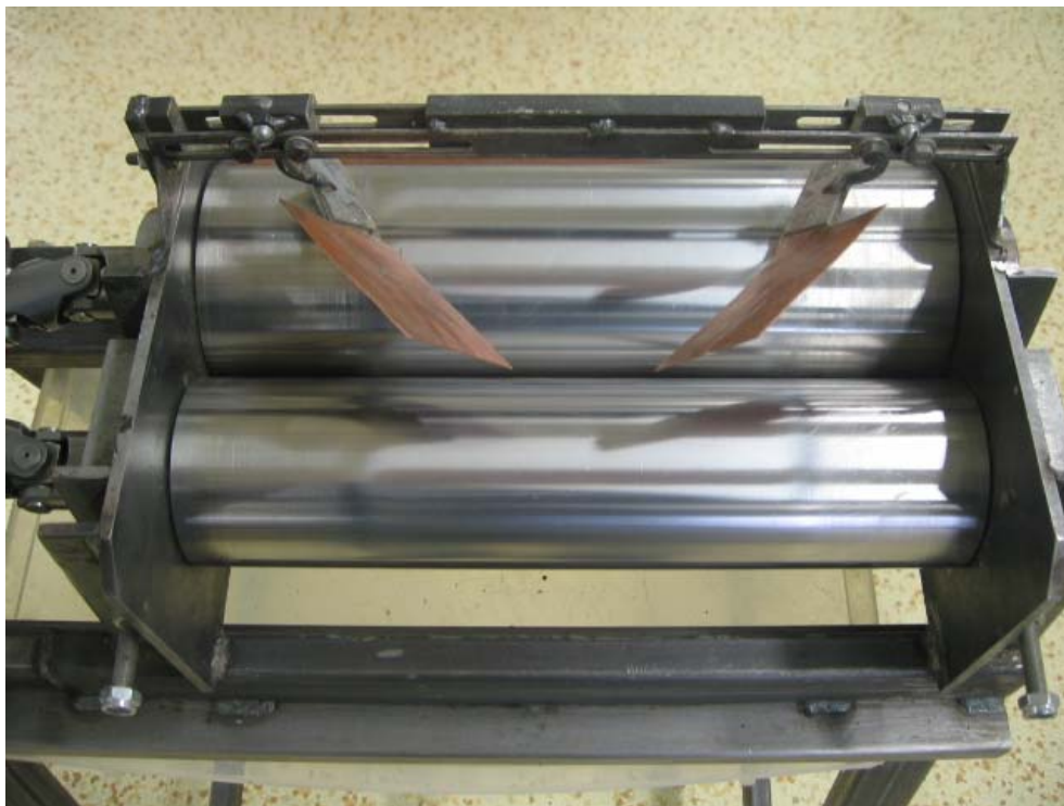
Obrázek č.17: Twin roll mixer – detail pracovního prostoru
