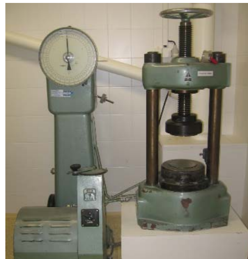
Obrázek č.19: Michaelisův přístroj a tlakový lis na měření mechanických vlastností trámců
