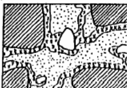
Obrázek č.6: Grafické znázornění tvorby polymer-cementového co-matrixu
