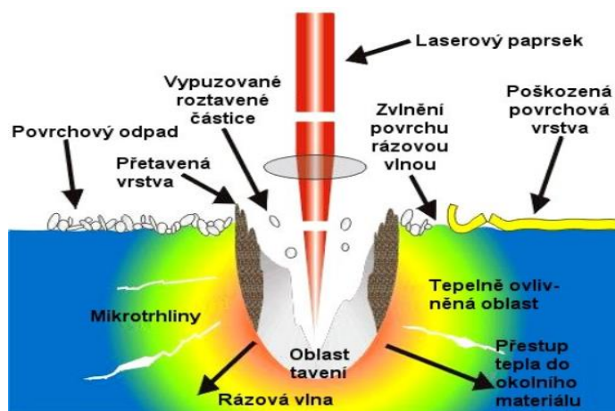
Obr. 12 - Působení laserového paprsku (HUMÁR, 2005)
