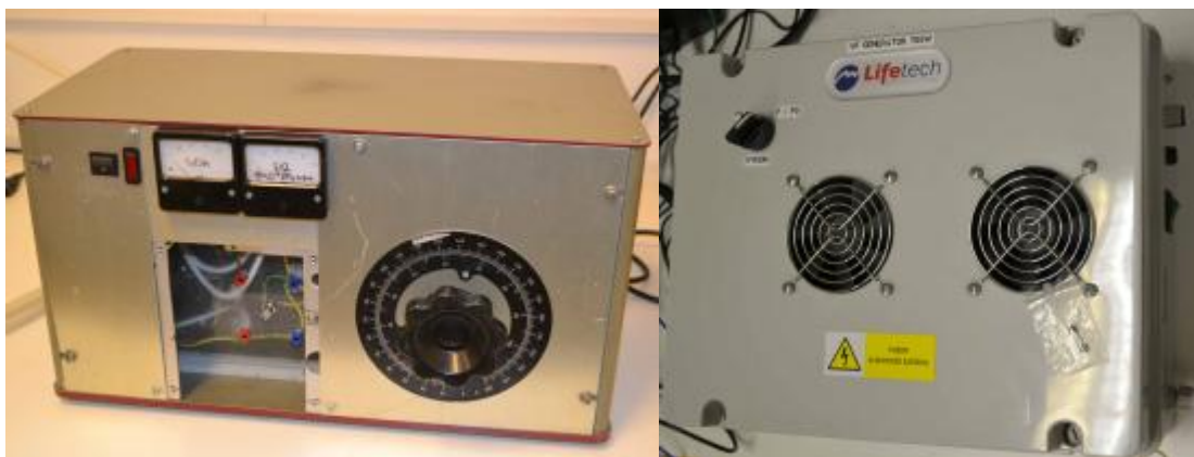
Obr. 6: Zdroj stejnosměrného napětí (vlevo) a zdroj vysokofrekvenčního napětí (vpravo).
