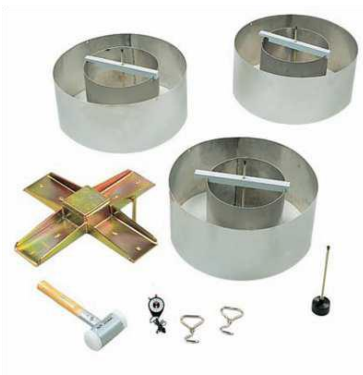
Obr. 9 Dvojvalcový infiltrometer (URL3)
