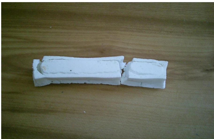
Obrázek 17: Deformace kostního porcelánu na bázi hlinitanového cementu při teplotě výpalu 1300 °C
