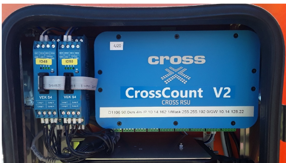
Obr. 14 – Sčítač dopravy ASD3u v SOS hlásce [autor]
