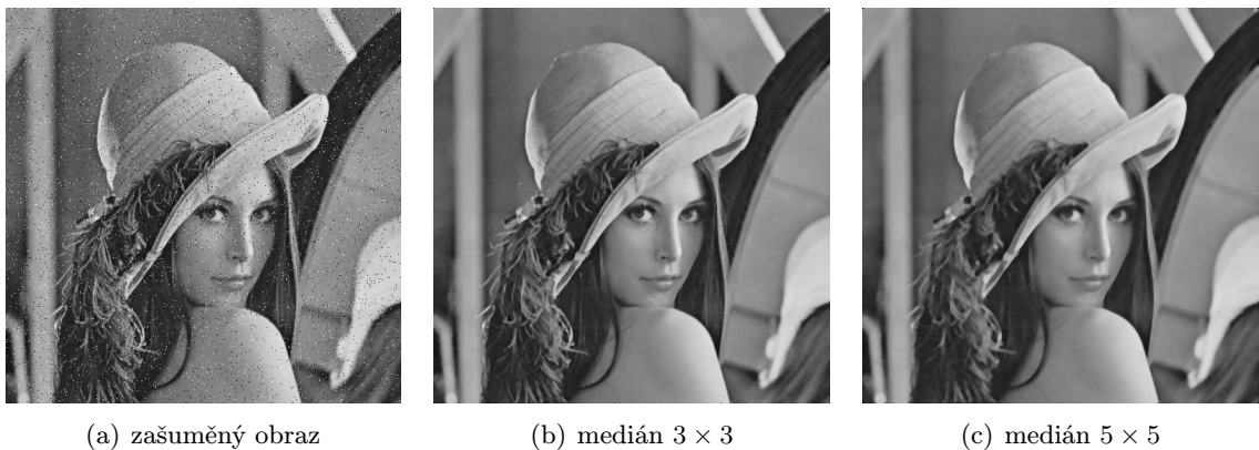
Obrázek 4.3: Filtrace šumu typu sůl a pepř mediánovým filtrem.
