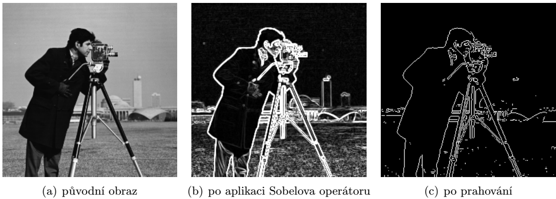
Obrázek 4.4: Detekce hran pomocí Sobelova operátoru.
