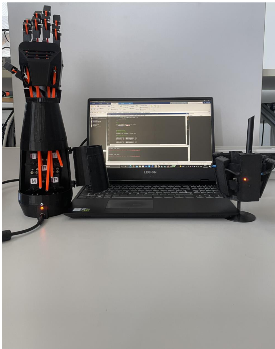
Obrázek č. 41: Kompletní sestava vyrobené protetické ruky s náramkem.
