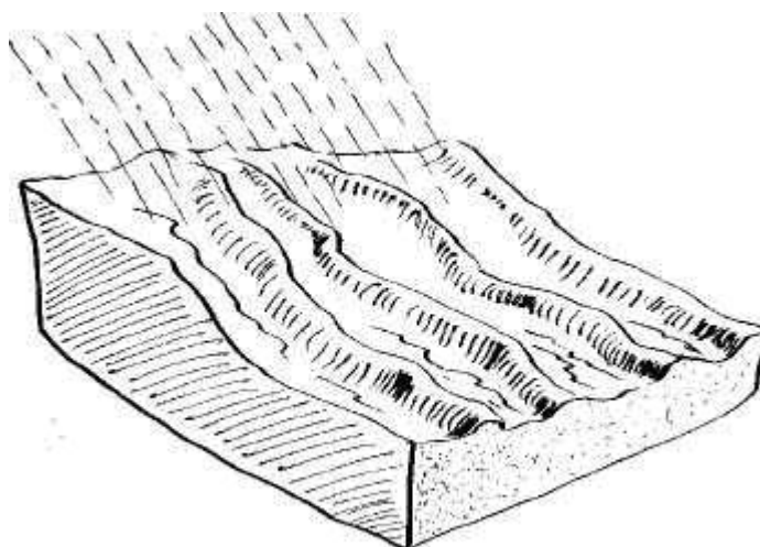
Obr. č. 2 Schéma výmolné eroze. Originál IIRR, (2010)
