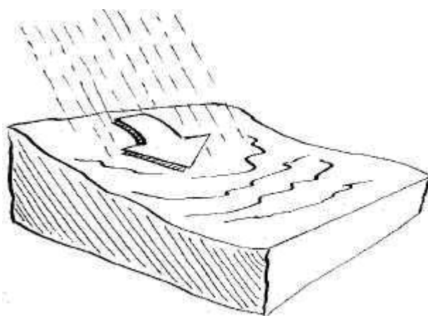
Obr. č. 1 Schéma plošné eroze. Originál IIRR, (2010)
