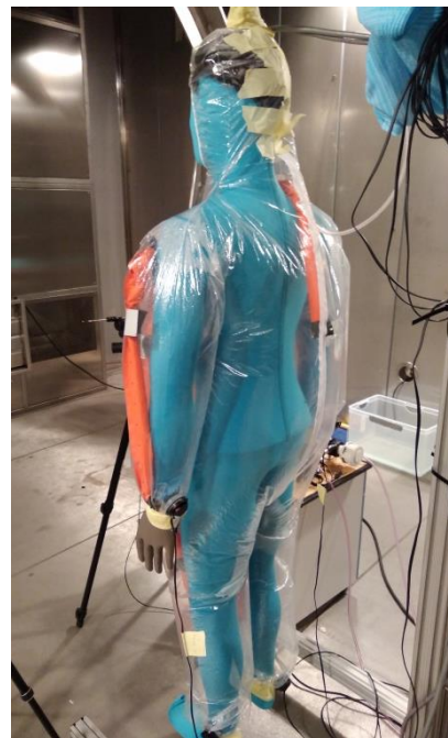
Obrázek 2.35 Plně osazený overall - vzduchovod vedený na záda
