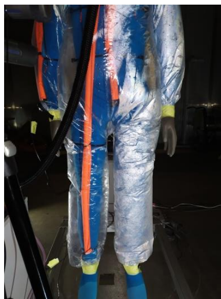
Obrázek 2.23 Snímek tepelného manekýna 15 minut po spuštění ventilace
