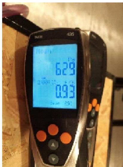
Obrázek 2.15 Naměřený průtok a tlaková diference na pravém rukávu
