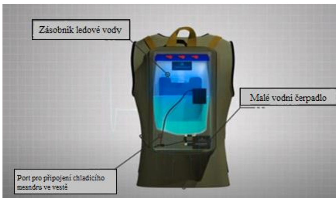
Obrázek 1.9 Vesta chlazená prouděním vody - zásobník vody [20]
