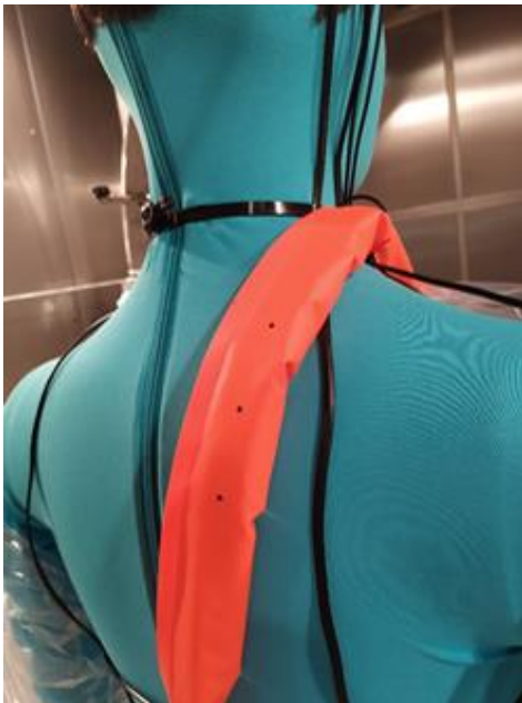
Obrázek 2.9 Detail perforovaného vzduchovodu
