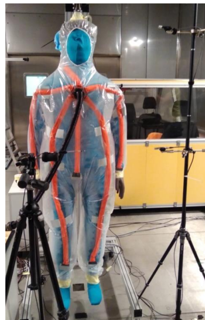
Obrázek 2.42 Tepelný manekýn 5 minut po spuštění – plně osazený overall
