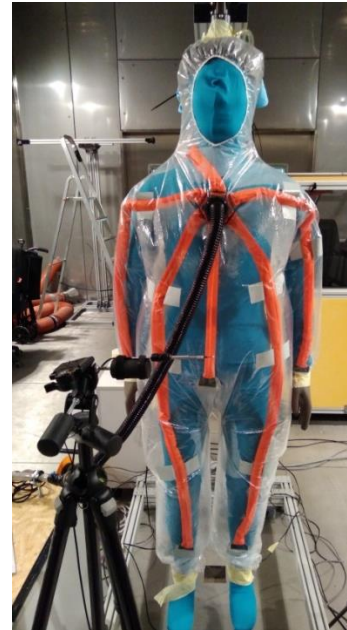
Obrázek 2.44 Tepelný manekýn 15 minut po spuštění – plně osazený overall
