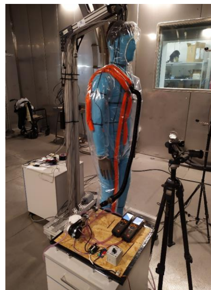
Obrázek 2.18 Umístění vzduchovodů do pravé části těla manekýna pod ochranným oděvem
