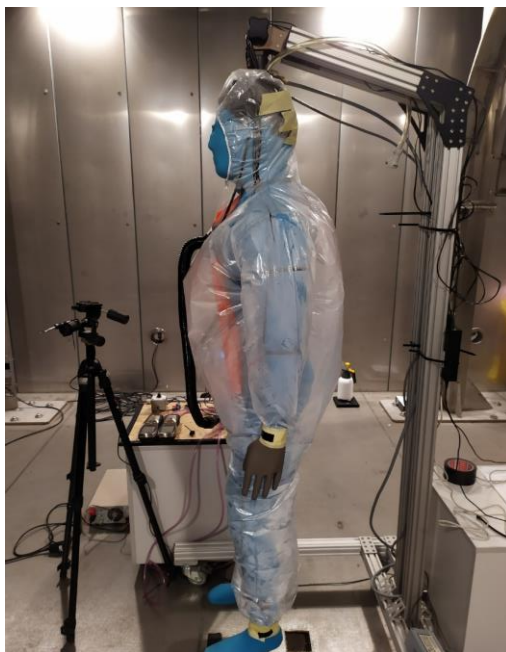
Obrázek 2.11 Oděv nafouknutý ventilací
