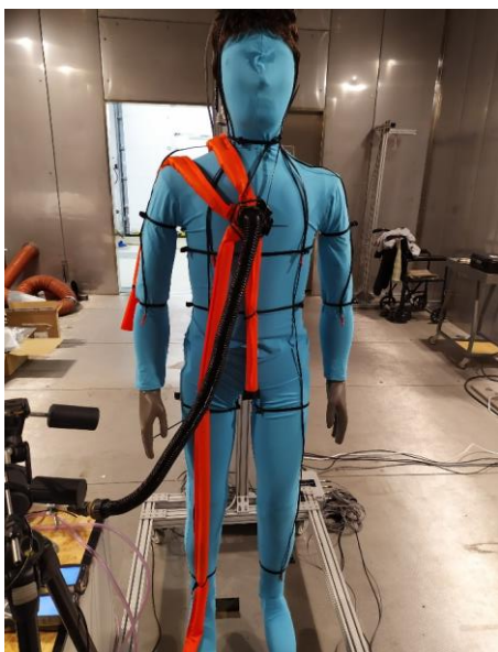
Obrázek 2.17 Umístění vzduchovodů do pravé části těla manekýna
