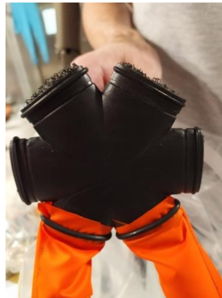
Obrázek 2.38 Pouze do nohou – ucpané rozvody vzduchu voštinou
