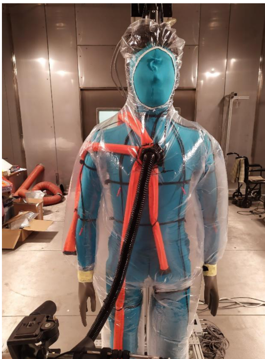
Obrázek 2.1 Tepelný manekýn v průběhu ověřování hypotézy 1
