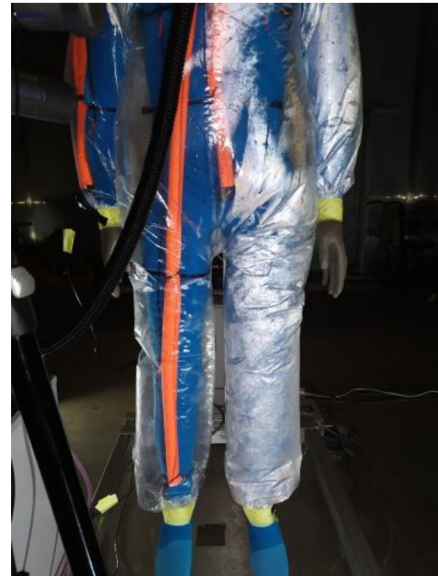
Obrázek 2.23 Snímek tepelného manekýna 15 minut po spuštění ventilace
