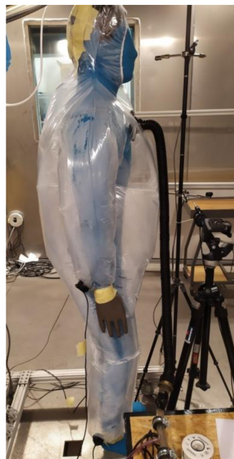
Obrázek 2.51 Tepelný manekýn z pravého profilu po oděni a stabilizaci
