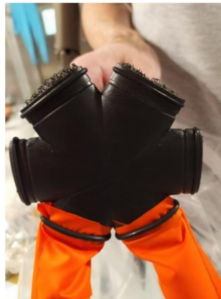
Obrázek 2.38 Pouze do nohou – ucpané rozvody vzduchu voštinou
