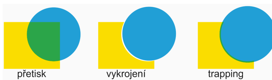
Obrázek 7: Rozdíl mezi přetiskem, vykrojením a trappingem
