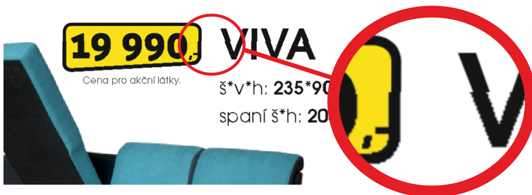
Obrázek 10: Nekorektní PDF po sloučení průhlednosti z aplikace CorelDRAW X7
