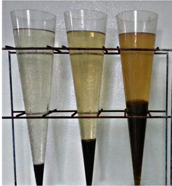
Obr. 2.1: Měření množství pevných látek metodou usazování i Imhoffově kuželu. [38]
