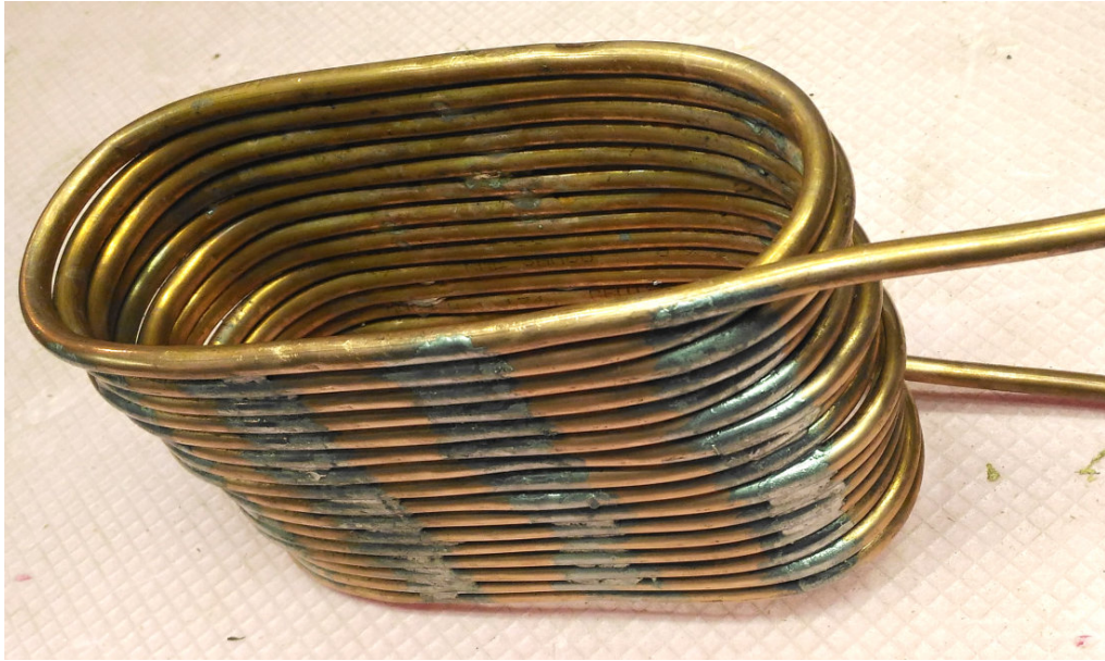
Obr. 3.6: Hrubě spájený svitek měděné trubky – bez kontaktních ploch
