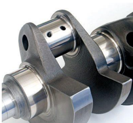
Obrázek 29 Kliková hřídel u které byli vytvořeny olejové kanálky pomocí elektroerozivní metody, zdroj: Orient express racing (2020)
