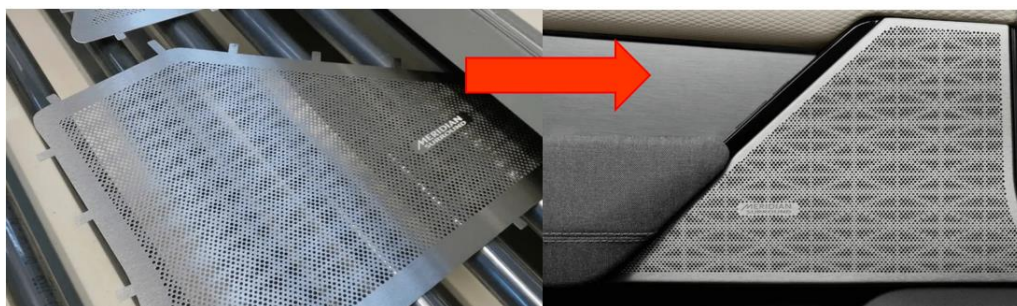
Obrázek 34 Mřížka reproduktorů z nerezové oceli vyrobené pomocí chemického obrábění, zdroj: Masteretch (2019)
