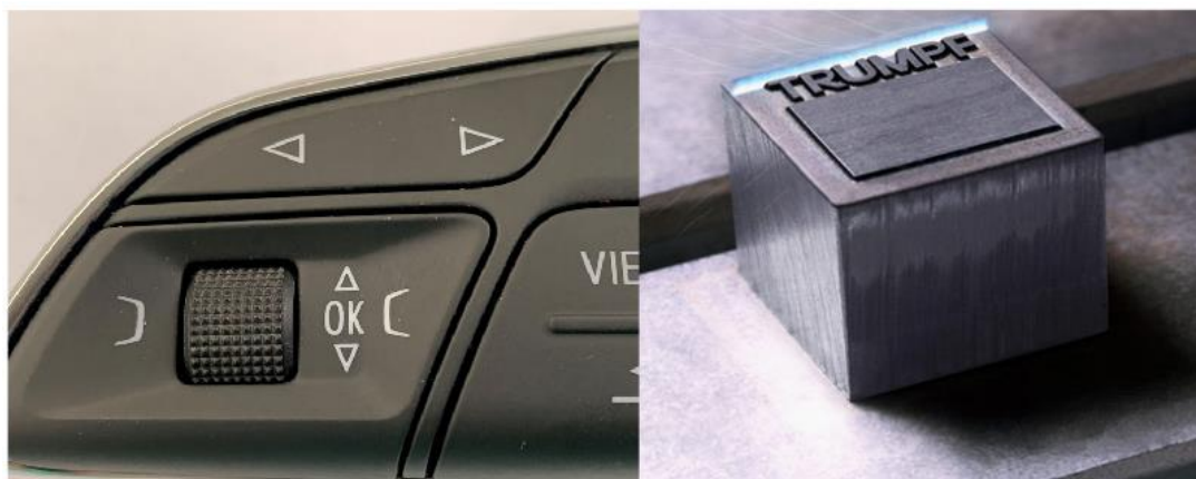
Obrázek 9 Vlevo plastový díl s popisky vytvářenými pomocí laseru, vpravo frézování emblému, zdroj: Plastic decoration(2016)
