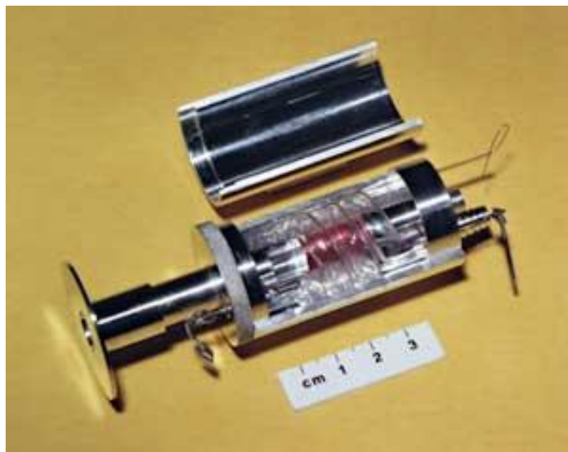
Obrázek 1 První funkční laser sestavený Theodorem Maimanem, zdroj: Engineering and Technology History Wiki. (2019)
