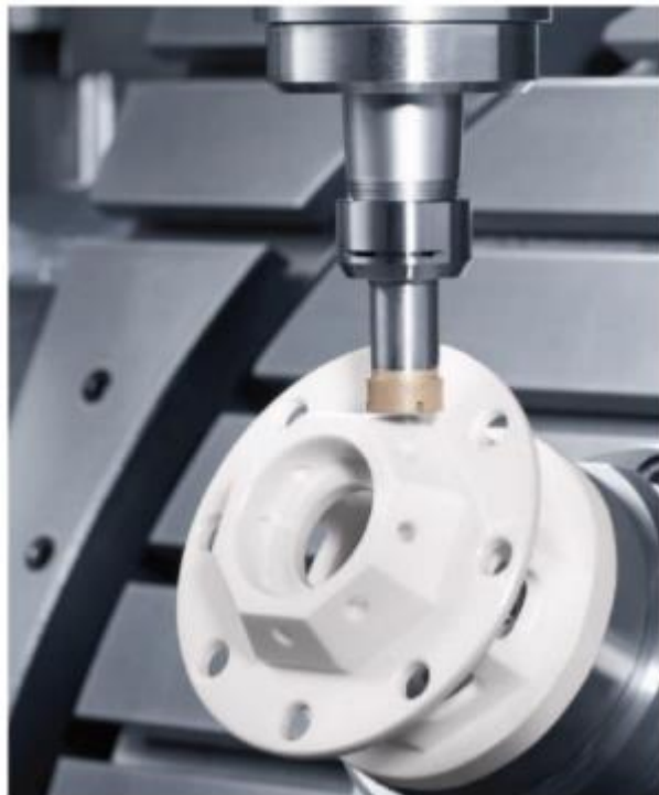
Obrázek 38 Obrábění keramické příruby pomocí ultrazvukového obrábění zdroj: Complete machinig with enhanced (2016)
